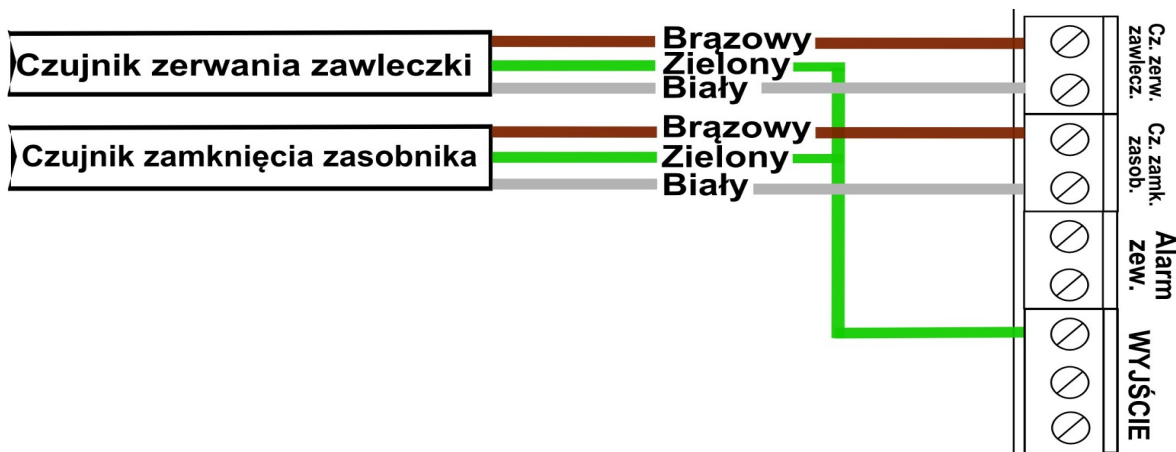
Ilustracja 6: Podłączenie czujników: zerwania zawleczki oraz zamknięcia zasobnika
